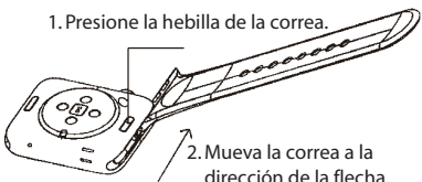
Correa larga de dismantling
