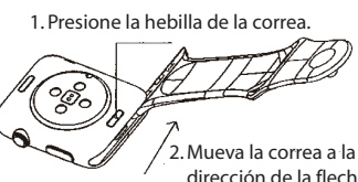
Dismantling correa corta
